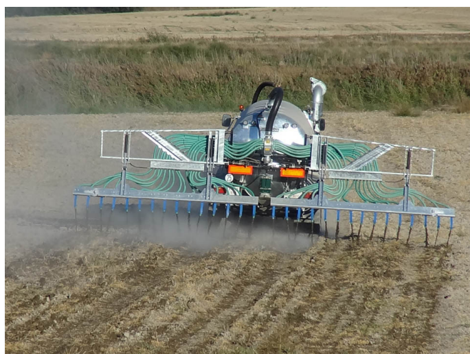
Aplicador de purín Beguer AB3, 9 metros de 30 salidas con triturador Vogelsang
